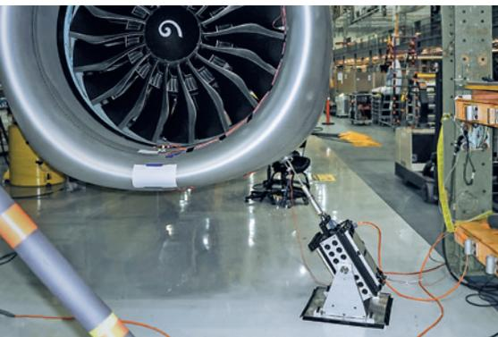
Strukturangeregung eines Triebwerks zur Modalanalyse in der Luftfahrt
