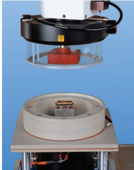
Schwingprüfung von kleinen Baugruppen unter Thermostream®
